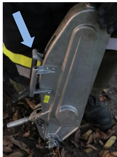
Abb.: Lösen der Klemmvorrichtung mittels Freischalthebel
