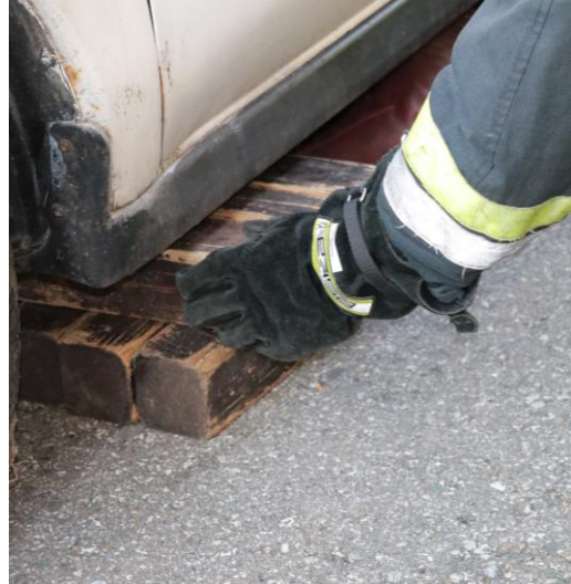
Abb.: Stabilisation mittels Rüstholz (Kreuzbauweise)
