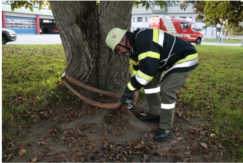
Abb.: Anbringen des Anschlagmittels am Fixpunkt
