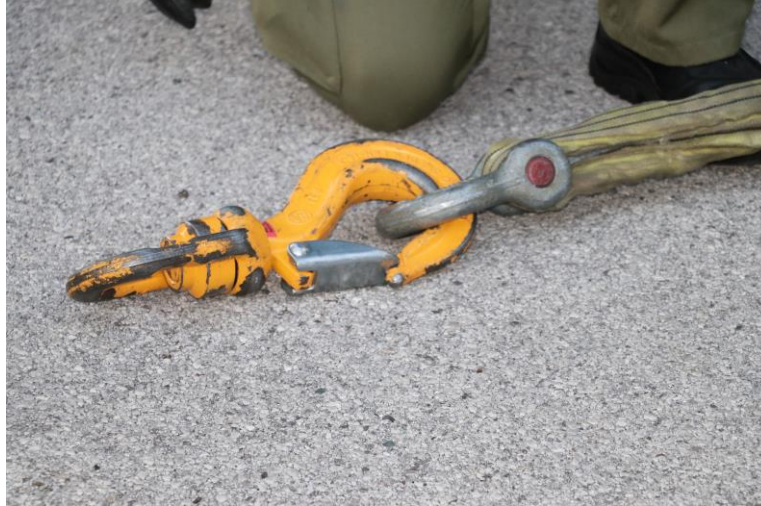
Abb.: Ende des Anschlagmittels mit Schäkel und drehbarem Lasthaken
