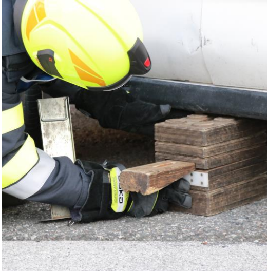
Abb.: Stabilisation mittels StabPack
