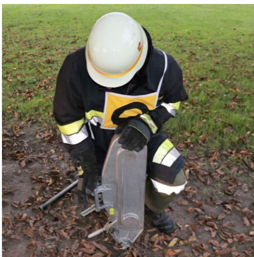
Abb.: Lösen der Klemmvorrichtung mittels Freischalthebel
