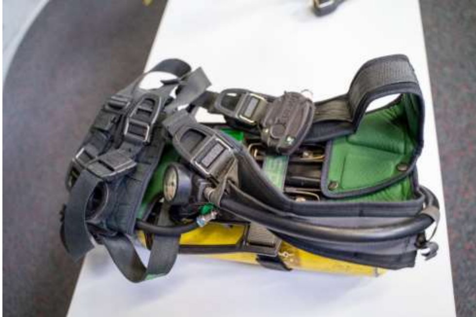
Abb. 31: Weitstellen der Befestigung
