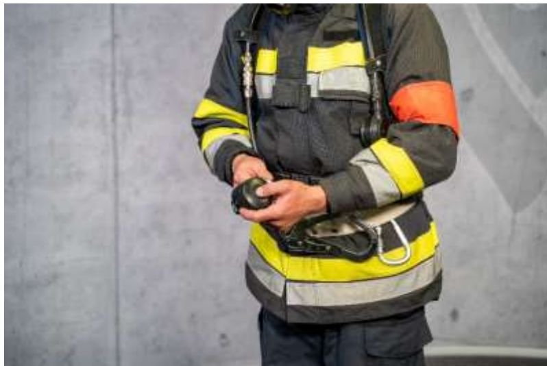
Abb. 7: Betätigen des Duschknopfes am Lungenautomat
